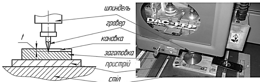
Рис. 4. Налаштування фрезерно-гравірувального верстата моделі Roland EGX-400 при експериментальному дослідженні
